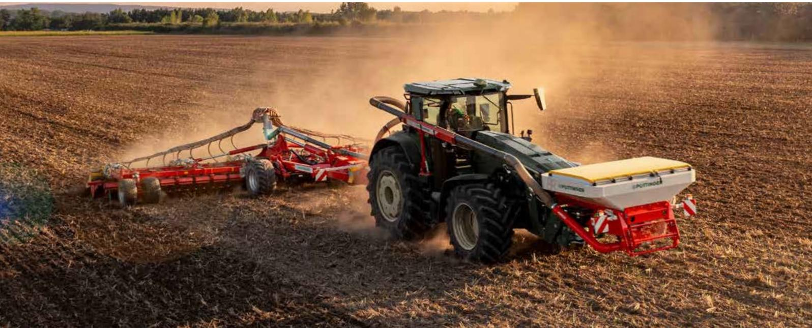
Der Tank AMICO bietet in Verbindung mit verschiedenen Ackerbaumaschinen die Möglichkeit Dünger bzw. Mikrogranulat, Zwischenfrüchte oder zwei Komponenten gleichzeitig auszubringen. Mit 1.700 bzw. 2.400 Liter Fassungsvermögen und einer Volumenaufteilung von 60:40 wird ein breites Einsatzspektrum gewährleistet.
