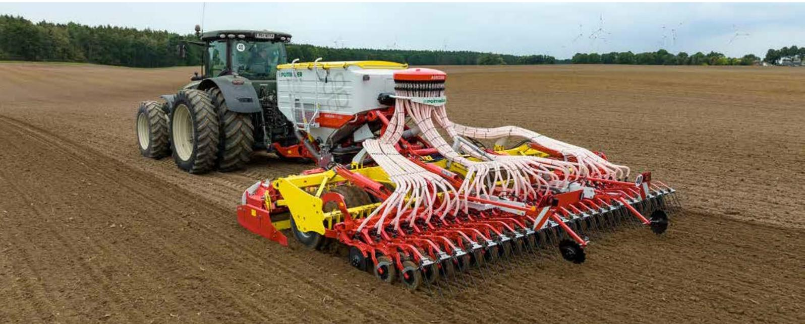
Die gezogenen AEROSEM Säkombinationen mit aktiver Bodenbearbeitung vereinen die Saatbettbereitung mit LION Kreiselegge, die Rückverfestigung mit Rillenreifenpacker und die Aussaat mit der DUAL DISC Säschiene. Das gezogene Sämaschinen-Konzept wurde für leichte bis hin zu schwersten Bodenarten entwickelt und wird erweitert durch die Profiline Komfortsteuerung. Diese ermöglicht die Ansteuerung aller hydraulischen Funktionen inklusive Schardruckverstellung, bequem von der Fahrerkabine aus.
