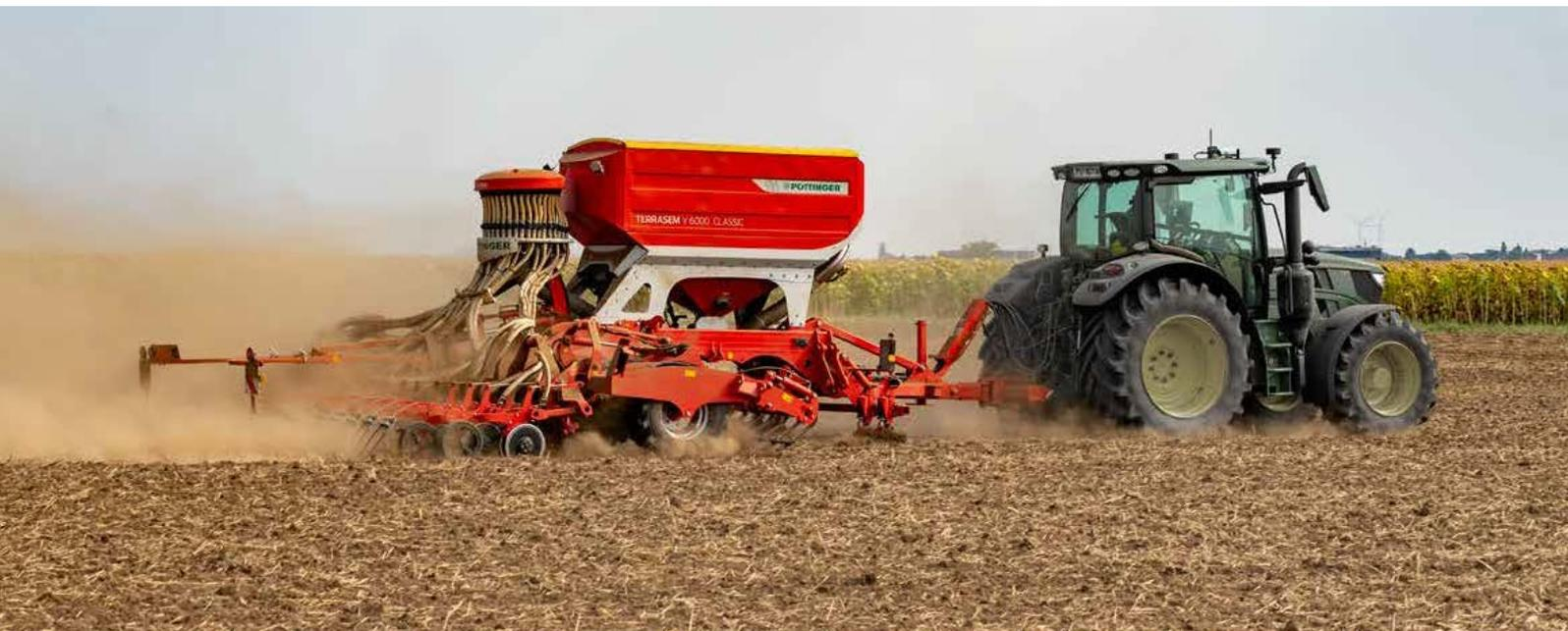
Die TERRASEM V CLASSIC Modelle ohne Vorwerkzeug bieten leichtzügige und schlagkräftige Großflächentechnik. Hier wird das Saatbett optimal eingeebnet – die Saatbettbereitung wird bereits vor der Aussaat erledigt. Dank optimaler Bodenanpassung der Säschiene und dem einzigartigen Reifenpacker wird eine perfekte Saatgutablage in ein rückverfestigtes Saatbett erreicht.
