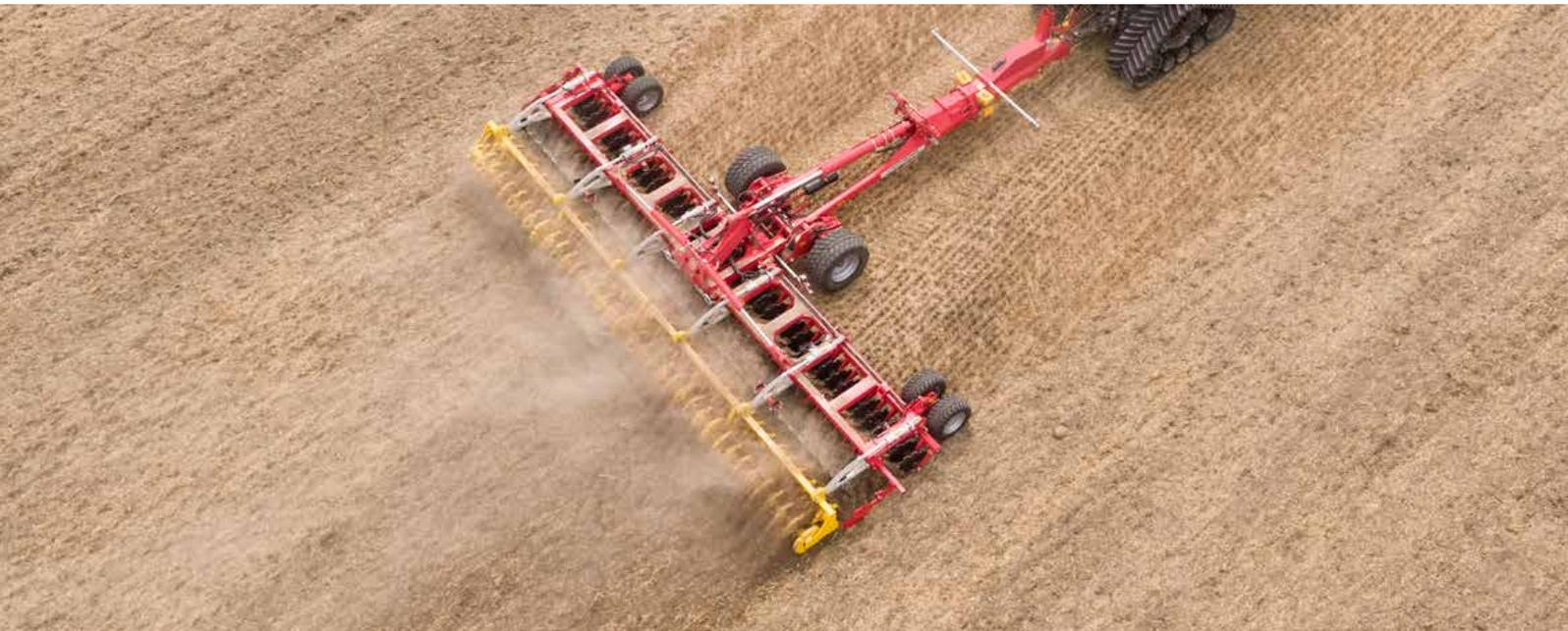
Die Kurzscheibenegge TERRADISC wurde für den Stoppelsturz und zur allgemeinen Saatbettbereitung entwickelt. Die kompakte Bauweise sowie die aggressive Scheibenstellung sorgen für sicheren Einzug und gute Durchmischung der Ernterückstände.
