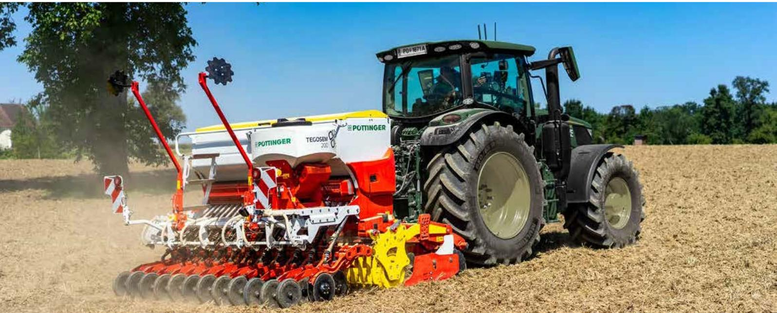
Der flexible Tank TEGOSEM kombiniert die Bodenbearbeitung und Ausbringung von Zwischenfrüchten sowie Untersaaten in einem Arbeitsschritt, und sorgt so für Zeit- und Kostenersparnis. Die TEGOSEM ist sowohl mit angebauten als auch gezogenen Maschinen kombinierbar.
