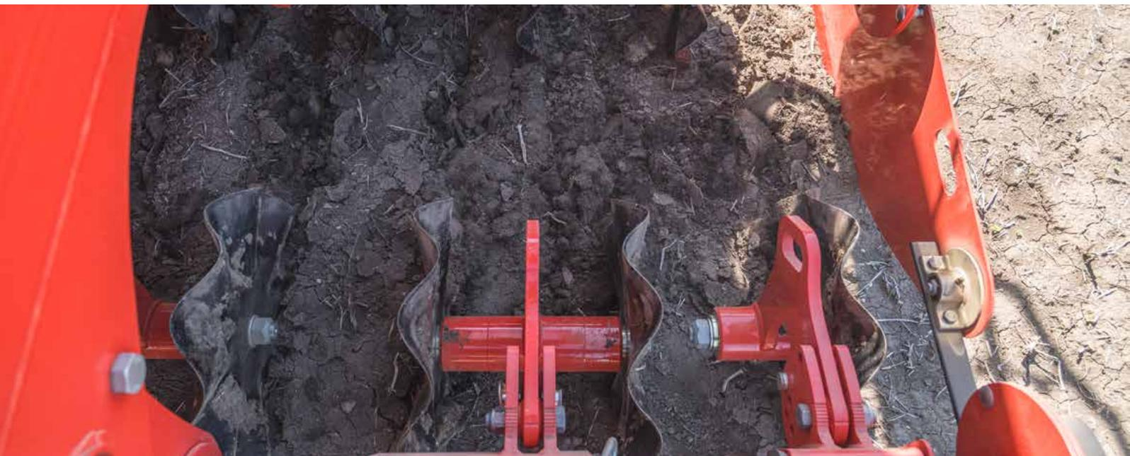
Die wartungsfreien WAVE DISC Wavelscheiben haben einen Durchmesser von 510 mm und sind mit einem Reihenabstand von 12,5 cm oder 16,7 cm verfügbar. Die Arbeitstiefe kann stufenlos hydraulisch verstellt werden. Das PÖTTINGER WAVE DISC System ist ideal geeignet für schwierige Bodengegebenheiten, welche eine reduzierte Bodenbearbeitung notwendig machen. Die Wavelscheiben WAVE DISC sind für alle TERRASEM Universalsädkombinationen erhältlich.
