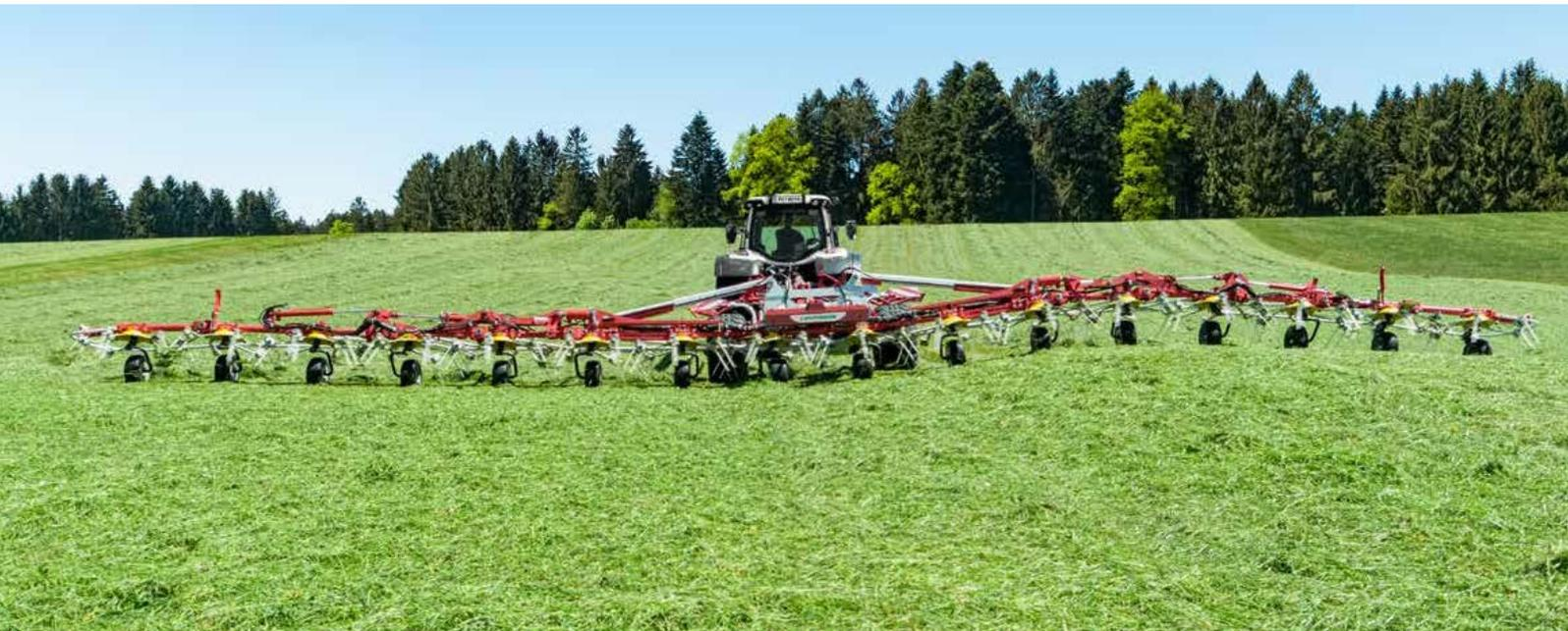
Unsere bewährten Zettkreisel überzeugen durch perfekte Bodenadaptation. Sowohl bei den Anbau- als auch bei den gezogenen Zettern reagieren nahe am Zinkeneingriff platzierte Tasträder auf jede Unebenheit. Zudem passen sich alle Rahmengelenke unabhängig voneinander an jede Kontur an. Die Zinken berühren nicht den Boden. Dies ermöglicht Ihnen futterschonendes Zetten ohne Schmutzeintrag.
