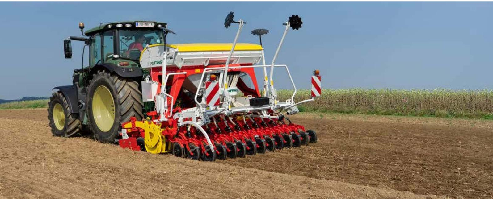
Das einzigartige AEROSEM Sämaschinen-Konzept vereint die Aussaat von Getreide und Mais. Die präzise arbeitende, universelle Dosierung und die vielfach bewährten Scharssysteme garantieren ein exaktes Ablegen des Saatgutes.
